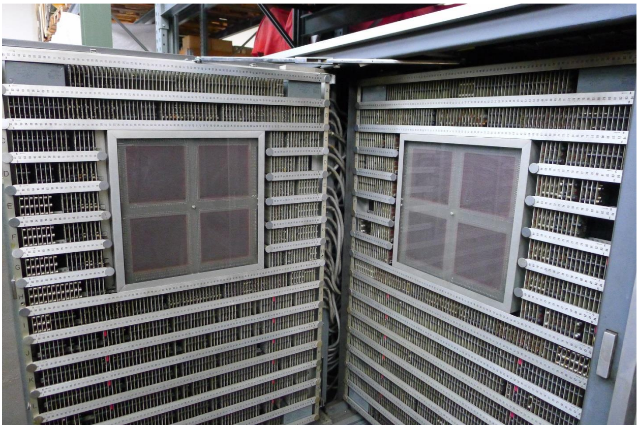
Bild 3: Schrank der CDC 1604-A mit den standardisierten Logik-/Funktionskarten und – in den mittleren Quadranten – mit dem Kernspeicher mit 32K Wörtern à 48 Bit.
